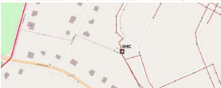
Рисунок 9 Схема отведения стоков за границами МО Все сточные воды, собираемые на территории технологической зоны, поступают на КОС ГУП «Водоканал Санкт-Петербурга» где проходят очистку и сбрасываются.
